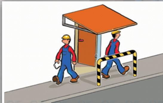
Barriera fissa conformata ad archetto ed evidenziata con bande trasversali oblique gialle e nere intervallate, a protezione della zona antistante una porta pedonale
